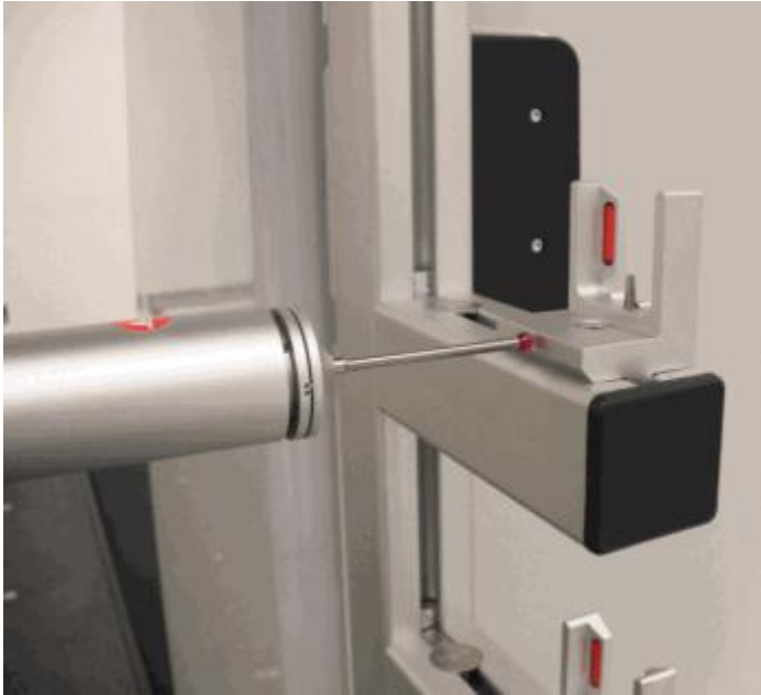
Horizontaler Messpunkt auf der ebenen, vertikalen Vorderseite des oberen Anschlusses
