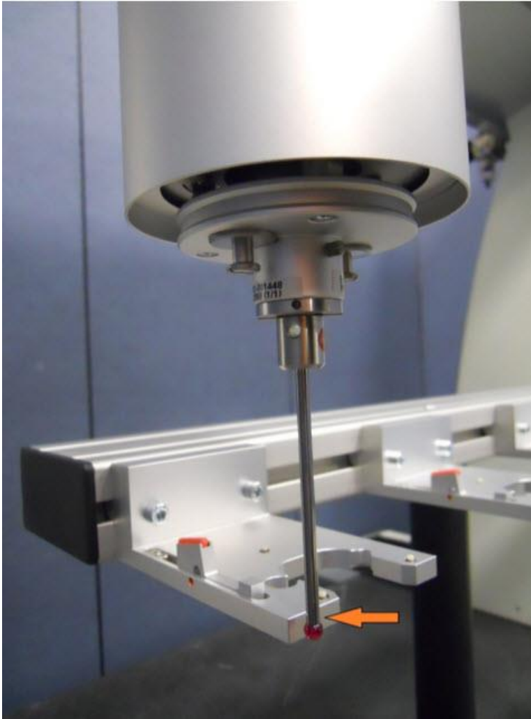
Beispiel für dritten Messpunkt an der Vorderseite des Anschlusses.
