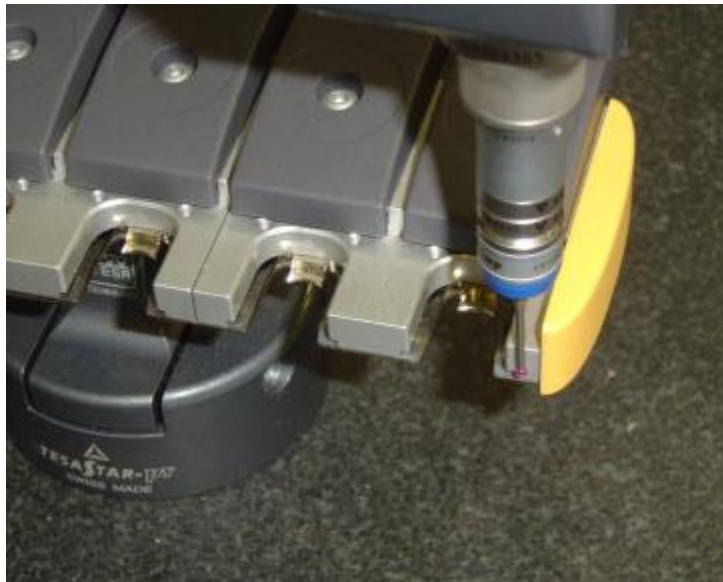
Lage des zweiten manuellen Messpunktes während Kalibrierung
