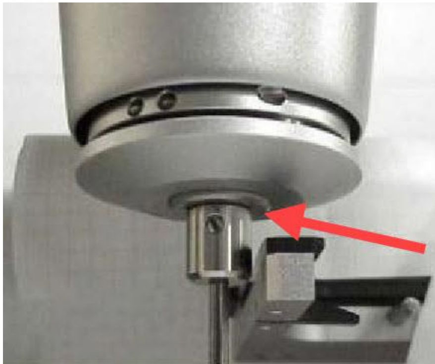
Position des ersten Messpunktes für Anschluss 1 am Überhang der Spannzange
