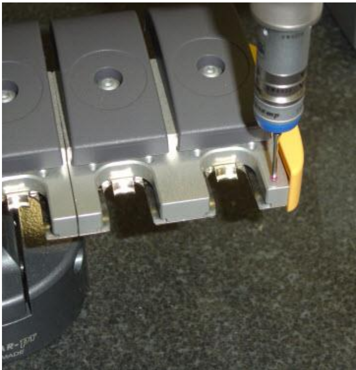
Lage des dritten manuellen Messpunktes während Kalibrierung
