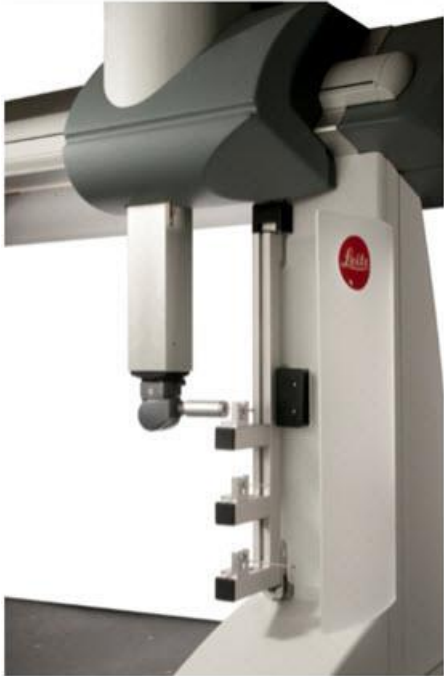
Montierter Tasterwechsler Travel Rack HR-X1-TR
