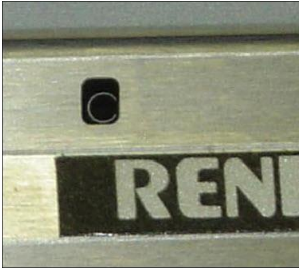
Beispiel für die visuelle Ausrichtung des Tasterwechslers.
