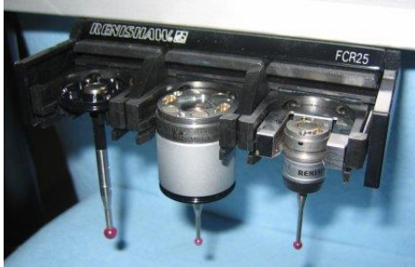
Tasterwechsler FCR25 - Anzeige von Einsätzen und Tastertypen
