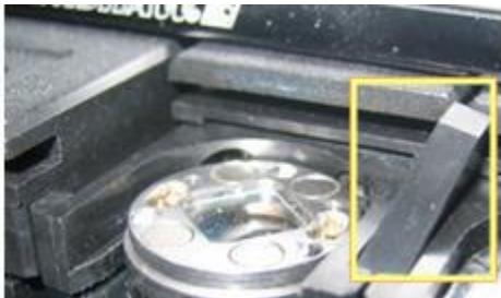
Unterlegkeil, der die Deckel von zwei Anschlüssen offen hält
