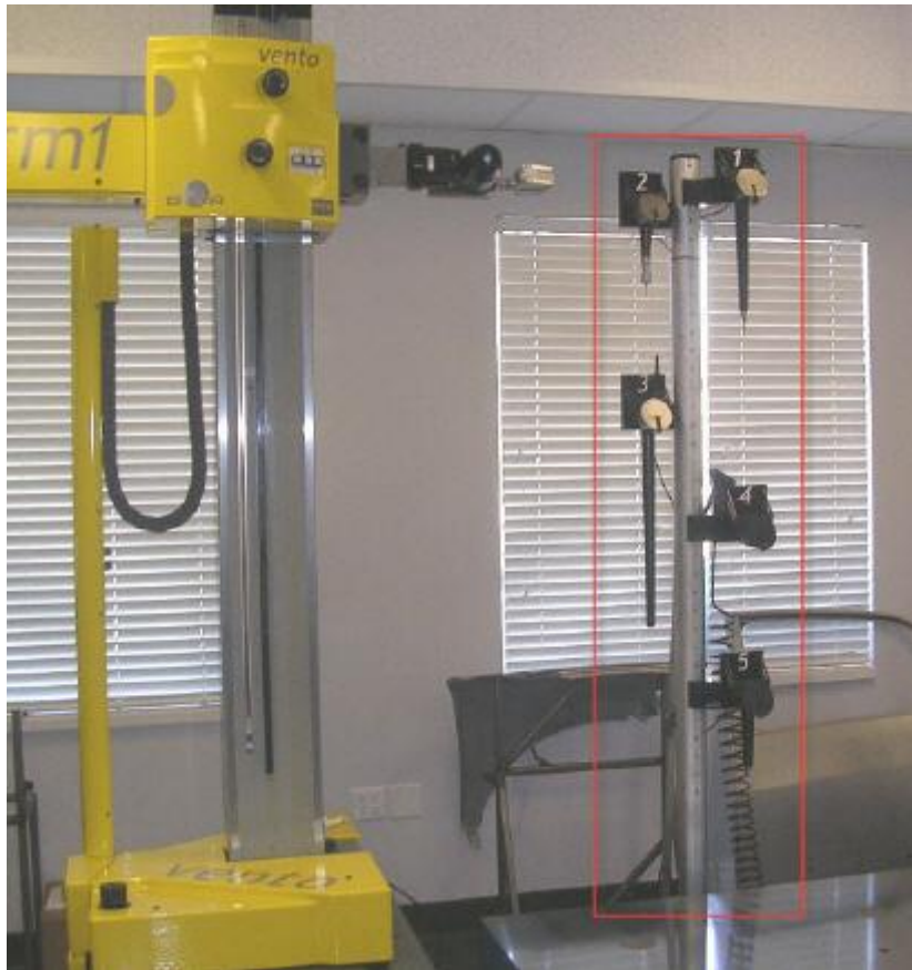
Vertikaler Tasterwechsler CW43 mit fünf Tasteranschlüssen
