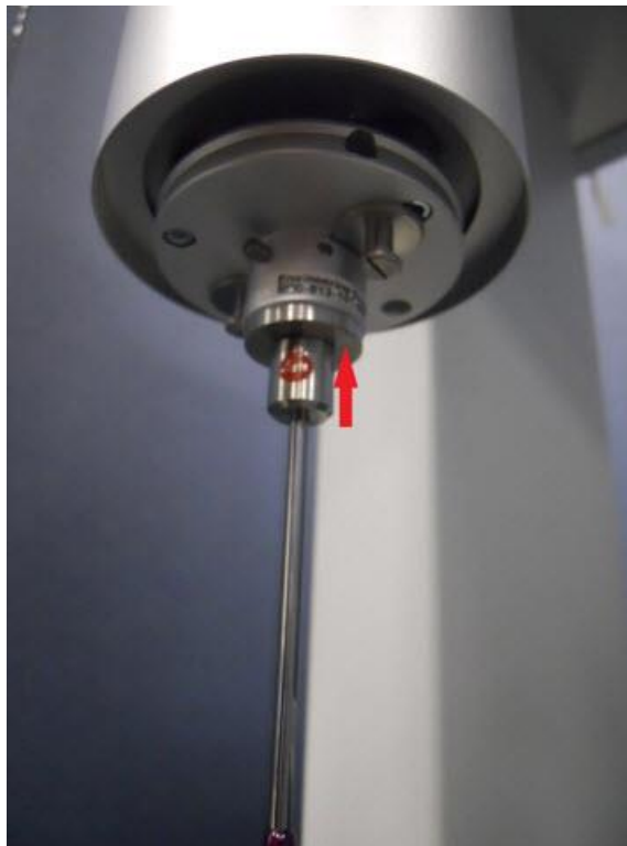
Überstand der Spannzange
